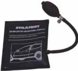
Der Beutel wird an einer bereits durchtrennten Stelle zwischen Scheibe und Karosserie geschoben und aufgepumpt. Durch das Anheben der Scheibe wird die restliche Kleberaube so unter Spannung gesetzt, dass diese nun viel leichter durchtrennt werden kann. Der Beutel aus faserverstärktem Gewebe ist extrem strapazierfähig und hat eine unglaubliche Belastbarkeit: Erst bei rund 150 kg öffnet das Ventil des Gummiballs.
