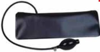
Der PowerLifter in langer Bauform kann flach oder gefaltet verwendet werden. So kann er die Scheibe von der Oberkante her deutlich weiter anheben. Damit ist der große PowerLifter noch umfangreicher einsetzbar als sein kleiner Bruder LB-300. Der Beutel aus faserverstärktem Gewebe ist extrem strapazierfähig und hat eine unglaubliche Belastbarkeit: Erst bei rund 150 kg öffnet das Ventil des Gummiballs.
